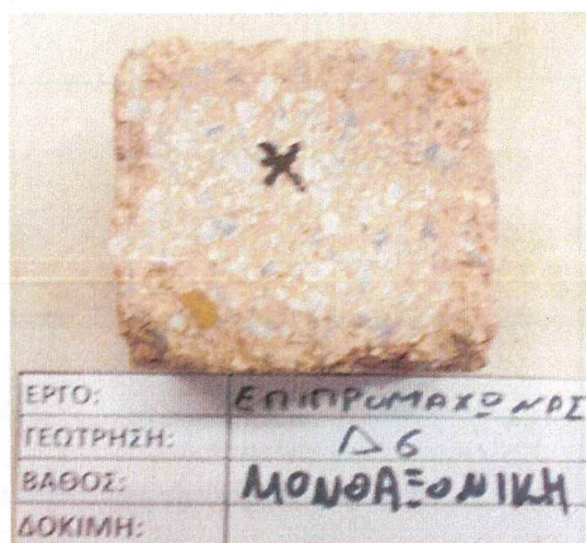
Φωτογραφία δοκιμίου πριν την αστοχία / Photograph of specimen before failure
